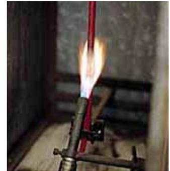
EN 60332-2-1:2004/BS EN 60332-2-1:2004/IEC 60332-2-1:2004/DIN EN 60332-2-1:2004/VDE 0482-2-1:2005-06标准是指在着火条件下，对电力电缆和光纤电缆的试验，该试验是指对单根小型绝缘电缆的垂直燃烧蔓延阻燃测试。
