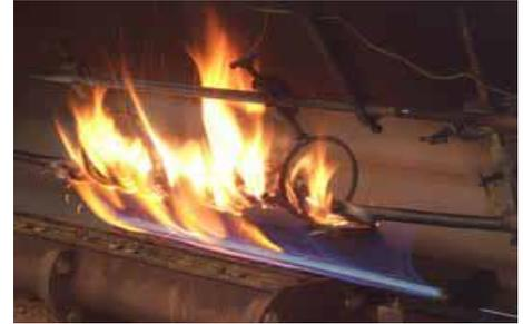
着火条件下电缆的试验 电路完整性第21部分【IEC 60331-21 (1999-04)】： 程序和要求—电缆额定电压不超过0.6/1KV。
