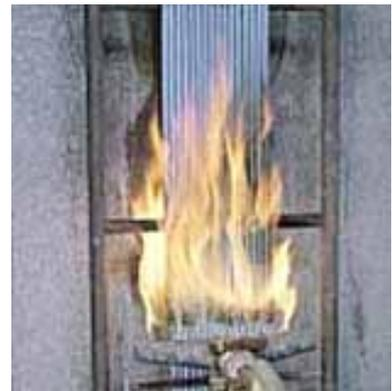
EN 50266-2-3:2001/BS EN 50266-2-3:2001/DIN EN 50266-2-3:2001/VDE 0482-266-2-3:2001-09标准的试验方法是在着火条件下，常用的阻燃试验方法。该试验是对垂直安装的成束电缆的垂直火焰蔓延的阻燃测试。第2 - 3 部分：程序。 B类（现在被EN 60332-3-2 3 :2009代替）
