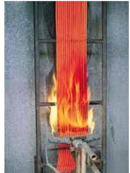
EN 60332-3-21:2009/BS EN 60332-3-21:2009/IEC 60332-3-21 ed1.1/DIN EN 60332-3-21/ VDE 0482-332-3-21:2010-08—该标准试验是在着火条件下对电缆常用的测试方法。该试验是着火条件下，电力电缆和光纤电缆的试验。第3-21部分是对垂直安装的成束电缆的垂直火焰蔓延试验 A F/R 类
